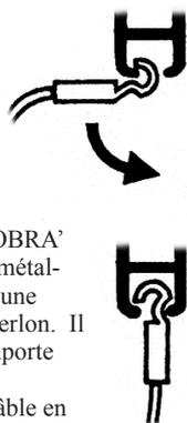
Les nouvelles suspensions 'COBRA' sont uniques grâce au crochet métallique de forme spéciale, fixé à une extrémité d'une longueur du Perlon. Il s'emboîte sur le rail 'C' à n'importe quel endroit, puis coulisse.
