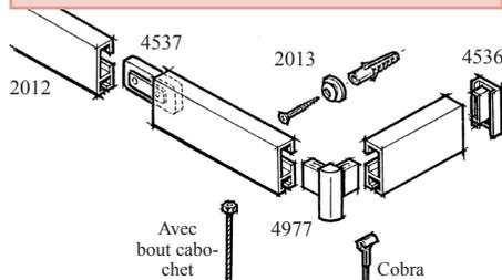
Rails Dissimulé 'C' (25 x 8,2mm). Discret et élégant. Aluminium extrudé blanc. 6m par paquet. S'enclenche sur les pattes de fixation vissés tous les 300mm sur le mur.
