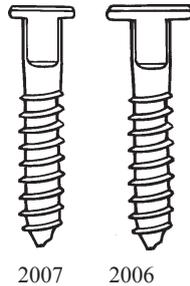
La vis en T a une tête en T, et ses cotés sont plats. Elle s'utilise avec une clé spéciale. Fixez la vis au mur, en faisant attention à son positionnement. Vous posez alors le cadre par dessus et vous faites pivoter la tête afin de l'engager dans la cannelure du cadre. Nos vis conviennent à la plupart des profils doubles Nielsen, Clark, Designer, etc...
