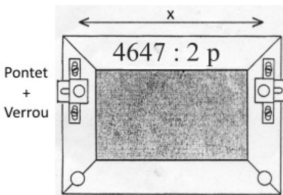
Marquez l'emplacement des vis sur le mur. Utilisez une bande de masquage pour éviter de marquer le mur. Utilisez toujours un niveau. Le pontet comporte des encoches pour permettre un réglage précis. Percez le mur puis posez les vis. Utilisez des vis de 6, 8 ou 10, au choix, et des chevilles ou des vis autoforeuses pour cloisons sèches selon les besoins. Laissez dépasser les têtes de vis d'environ 5 mm.
