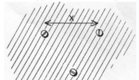
**Crochet à encoche** : crochet spécial à poser sur le montant supérieur du cadre, qui s'accroche sur les vis dans le mur.
