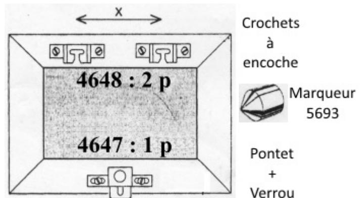
Posez deux vis dans le mur à une distance «X». Placez le marqueur dans la bride. Posez les crochets à encoche sur les vis dans le mur et appuyez sur le bas du cadre pour marquer l'emplacement de la troisième vis. Soulevez le cadre et retirez le marqueur. Posez la troisième vis dans le mur. Appuyez sur le verrou pour le bloquer.
